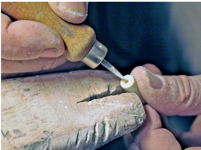
Abb. 11: Herstellung der Bohrung am Scharnierteil (Foto Matthias Streckfuß)
