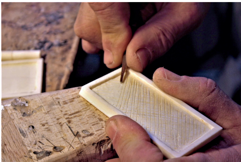
Abb. 10: Geißfuß zur Herstellung der Schraffur (Foto Matthias Streckfuß)
