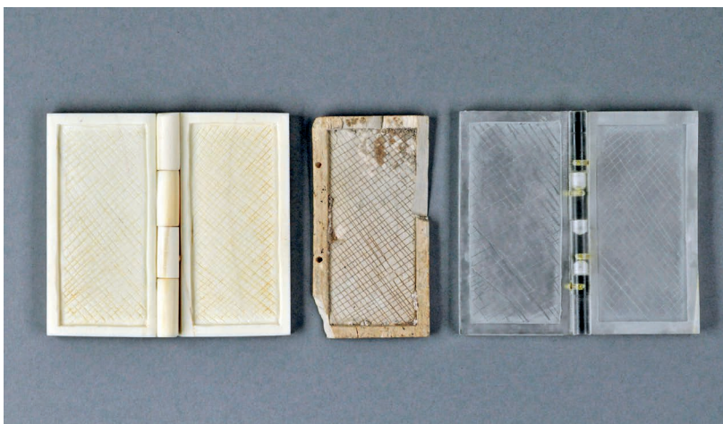
Abb. 15: Rekonstruktionsverlauf, von links nach rechts: materialgerechte Rekonstruktion, Original, Plexiglas-Modell (Foto Gert Jendritzki)
