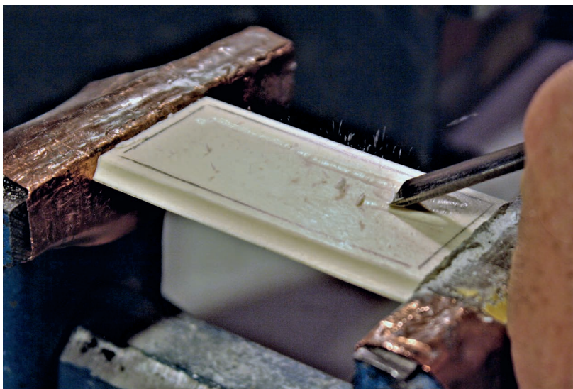
Abb. 9: Herausarbeiten der Vertiefung mit einem Stichel, oberhalb der Tafel sind die „spritzenden“ Späne erkennbar (Foto Matthias Streckfuß)
