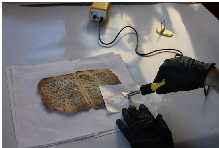
Fig. 12 - Spianamento con termocauterio.
