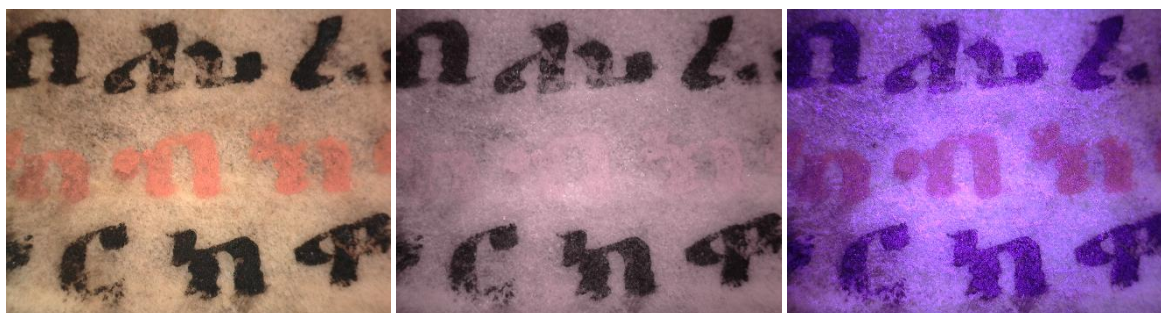
Fig. 19 - Particolare del testo di scrittura esaminato con microscopio Dino-Lite nello spettro del visibile (a sinistra), dell'infrarosso (al centro) e dell'ultravioletto (a destra).
