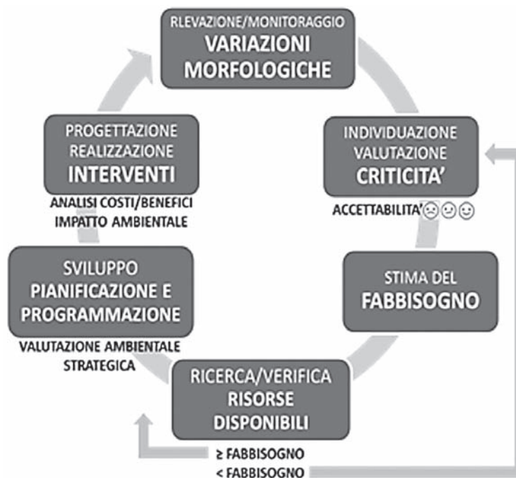
Fig. 5. Schema per un corretto approccio alla valutazione e gestione dell'erosione costiera
