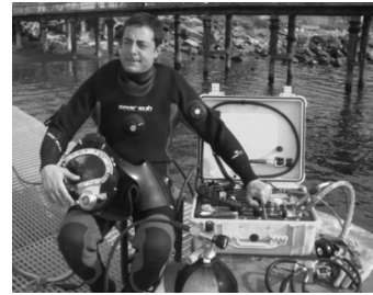
Fig. 4: Casco e stazione di comunicazione e sicurezza.
