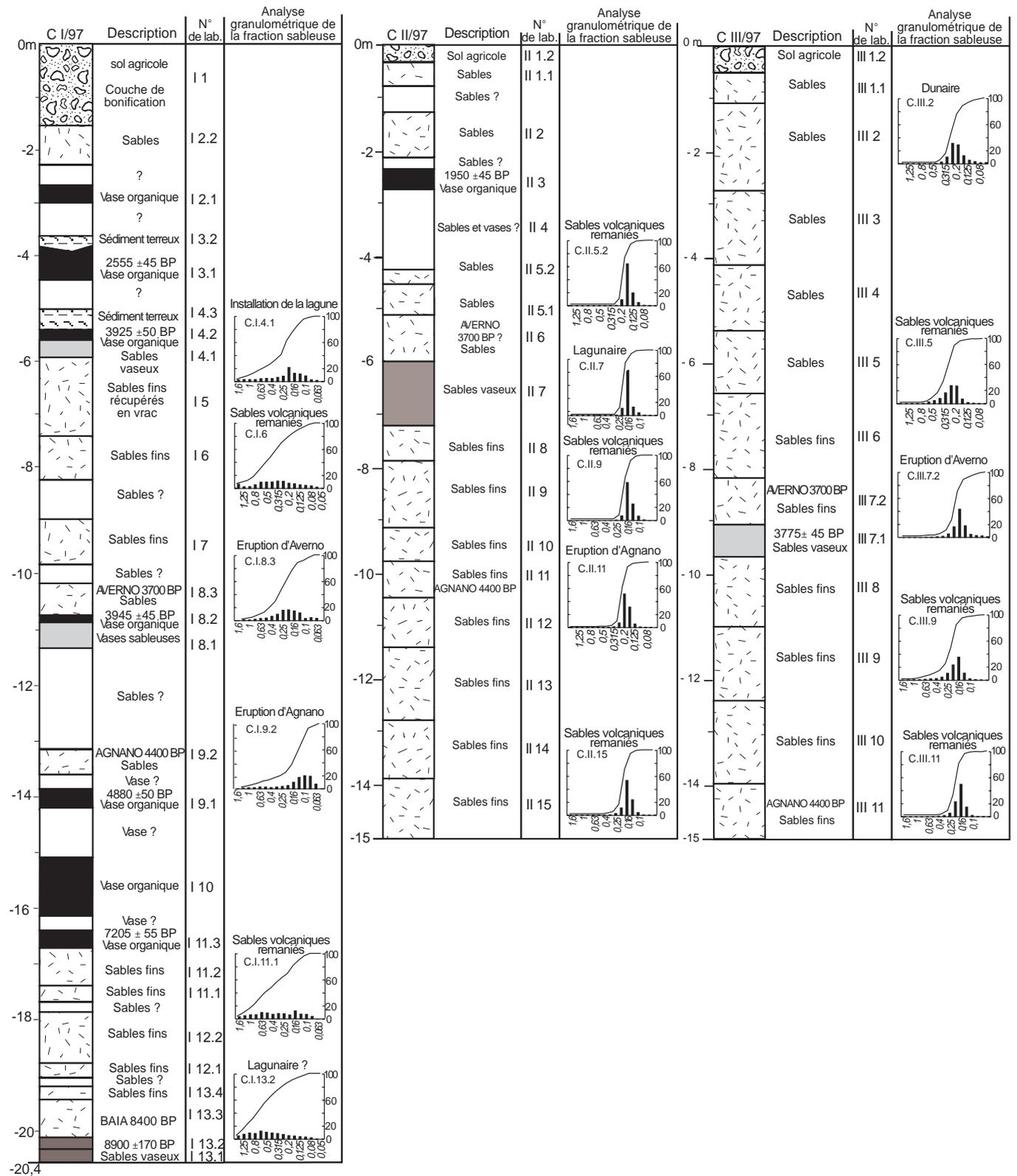
Fig. 4. Stratigrafia di tre carote prelevate ai piedi del versante settentrionale della collina di Cuma.
