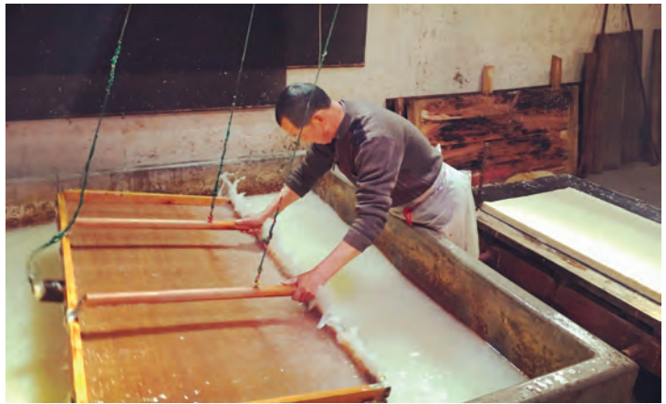
Fig. 3. Lavorazione della carta di Xuan.
