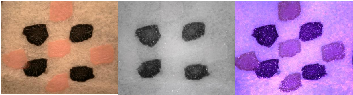
Fig. 22 – Particolare del testo di scrittura esaminato con microscopio Dino-Lite nello spettro del visibile (a sinistra), dell'infrarosso (al centro) e dell'ultravioletto (a destra).
