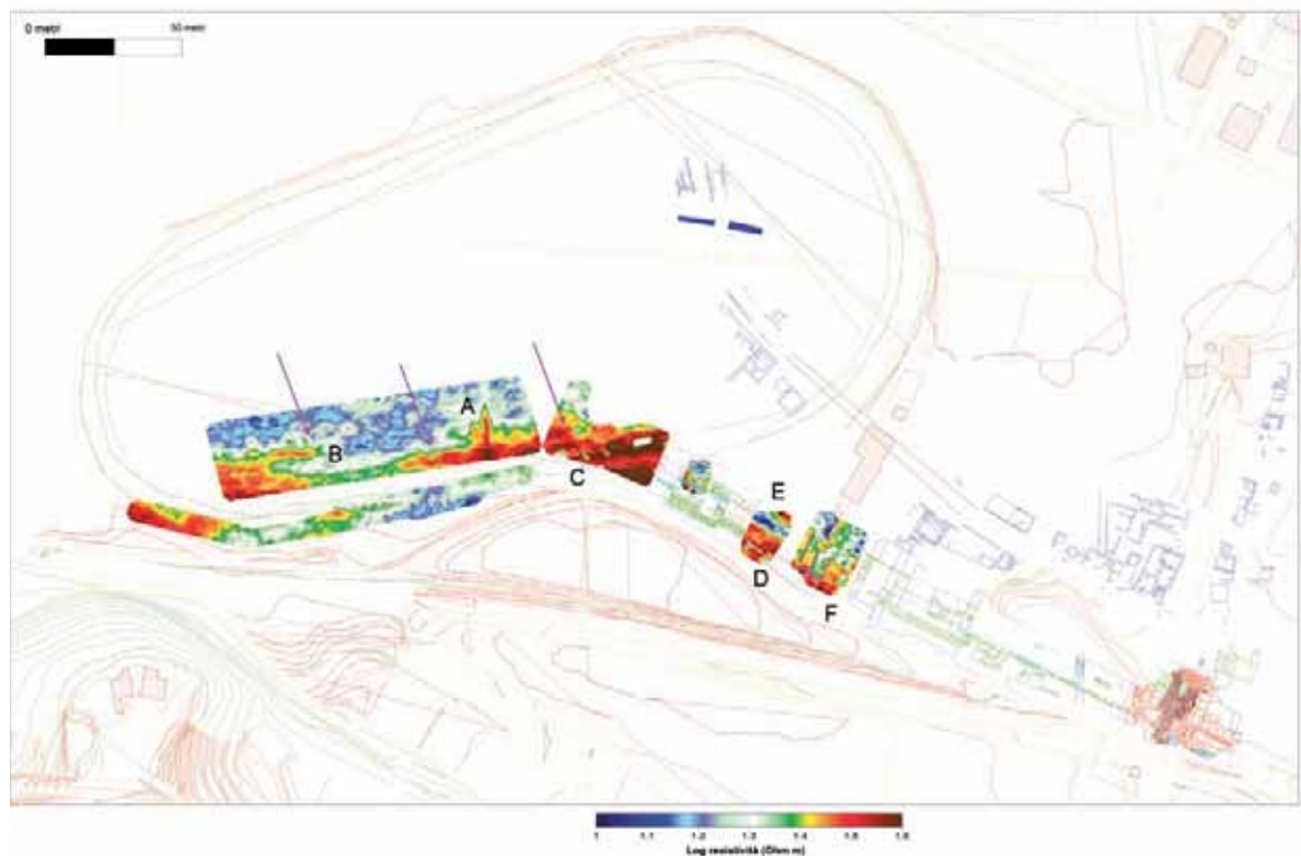
Fig. 175 Sezione tomografica relativa alla profondità di 1 m. con evidenza delle anomalie.
